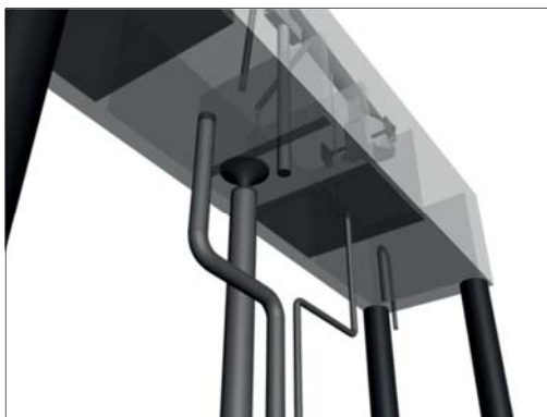
شکل (۱۹) - لوله‌کشی زیر حوضچه سیستم کنترل فواره چهارم تقی‌الدین
